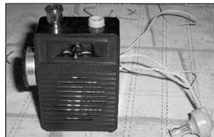
Obr. 2. Pohled na sestavený přijímač
